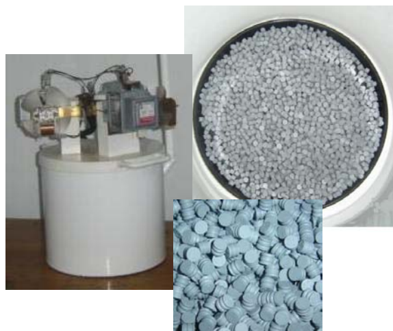
Figura 1 – Dispositivo gerador de microondas, com suporte de amostras giratório e amostras de borracha bromo butílica.
