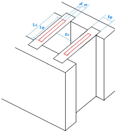
Figura 3. Detalhes de um Canal de Refrigeração.
