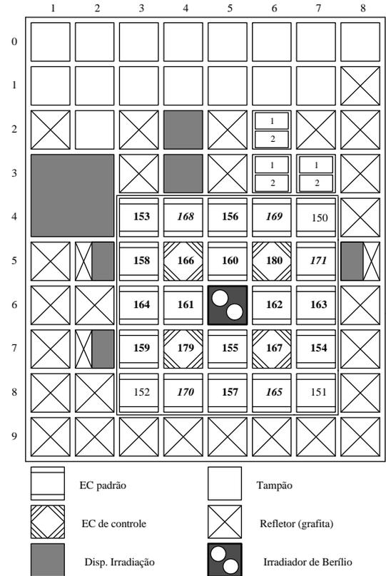
Figura 2. Configuração Utilizada.
