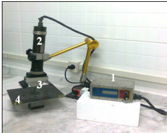
Figura 1. Analisador portátil de tensões por difração de raios X: (1) Unidade de controle de tensão e corrente; (2) Tubo de raios X; (3) Colimador; (4) Amostra analisada.
