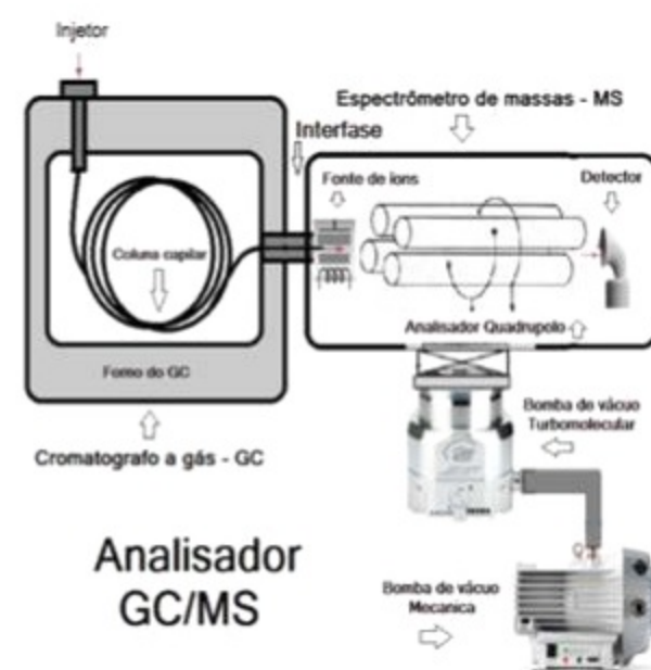
Figura 1: Analisador GC/MS. Constituído de dois compartimentos separados: um contém o GC e outro o MS. O GC está composto por: injetor da amostra, coluna cromatográfica e forno resistivo programável. O MS está formado por: fonte de íons, analisador de massas quadrupolo e detector de íons. O MS funciona sob alto vácuo obtido por meio de bomba turbomolecular e bomba mecânica de pré-vácuo.
