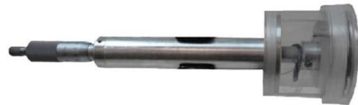
Figura 1: Fotografia da câmara de ionização de extrapolação caracterizada neste trabalho [3].
