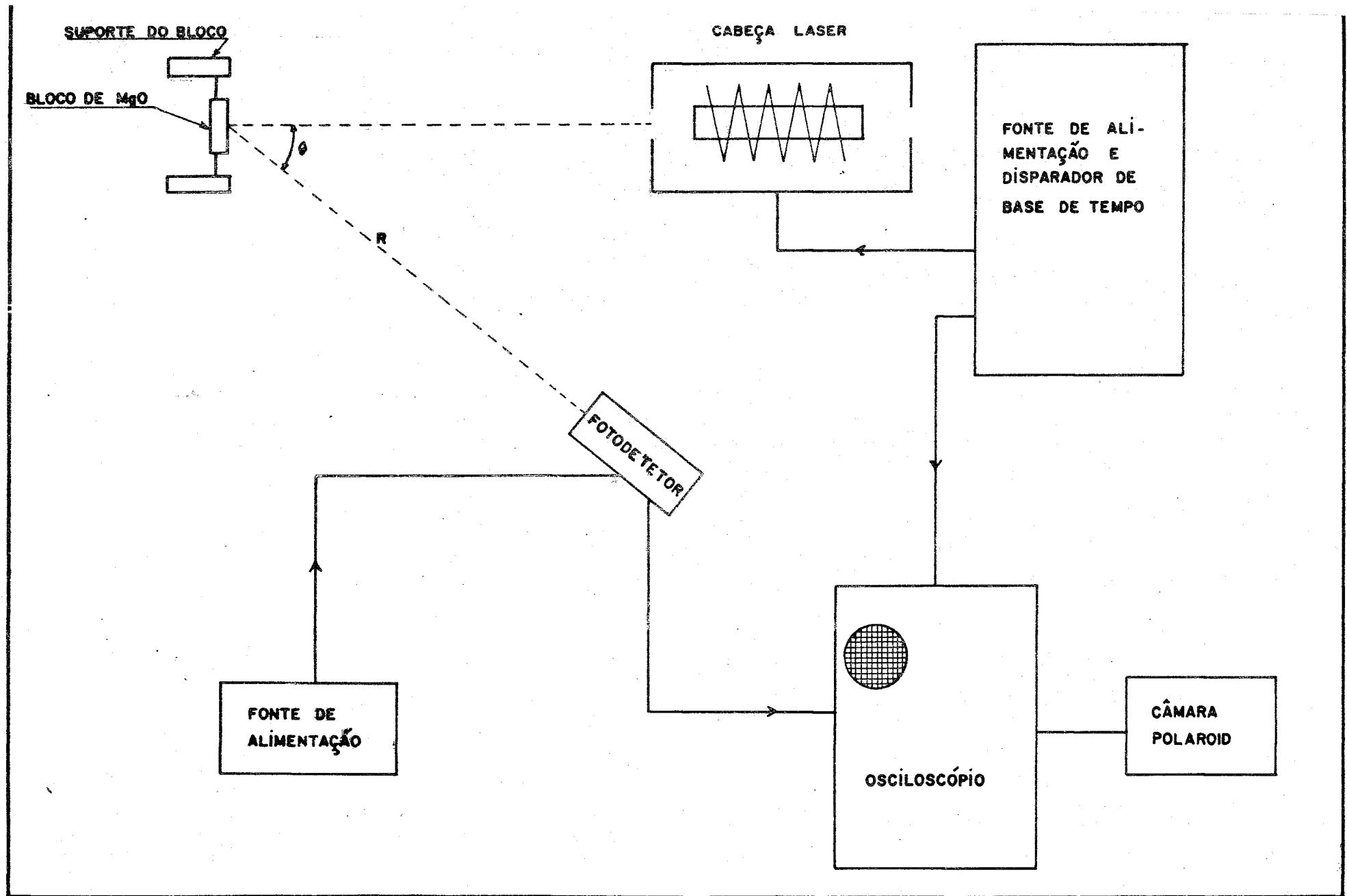
Fig.(A.2)- Arranjo Experimental para a medição da energia do laser.
