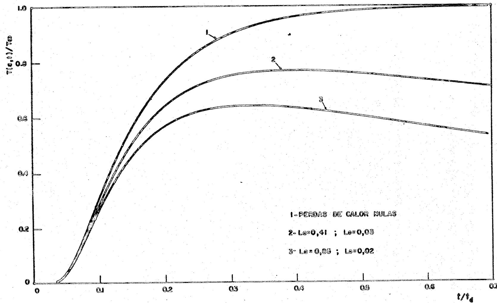
Fig.(2.4)- Efeito de perdas de calor, nas faces paralelas da amostra,
