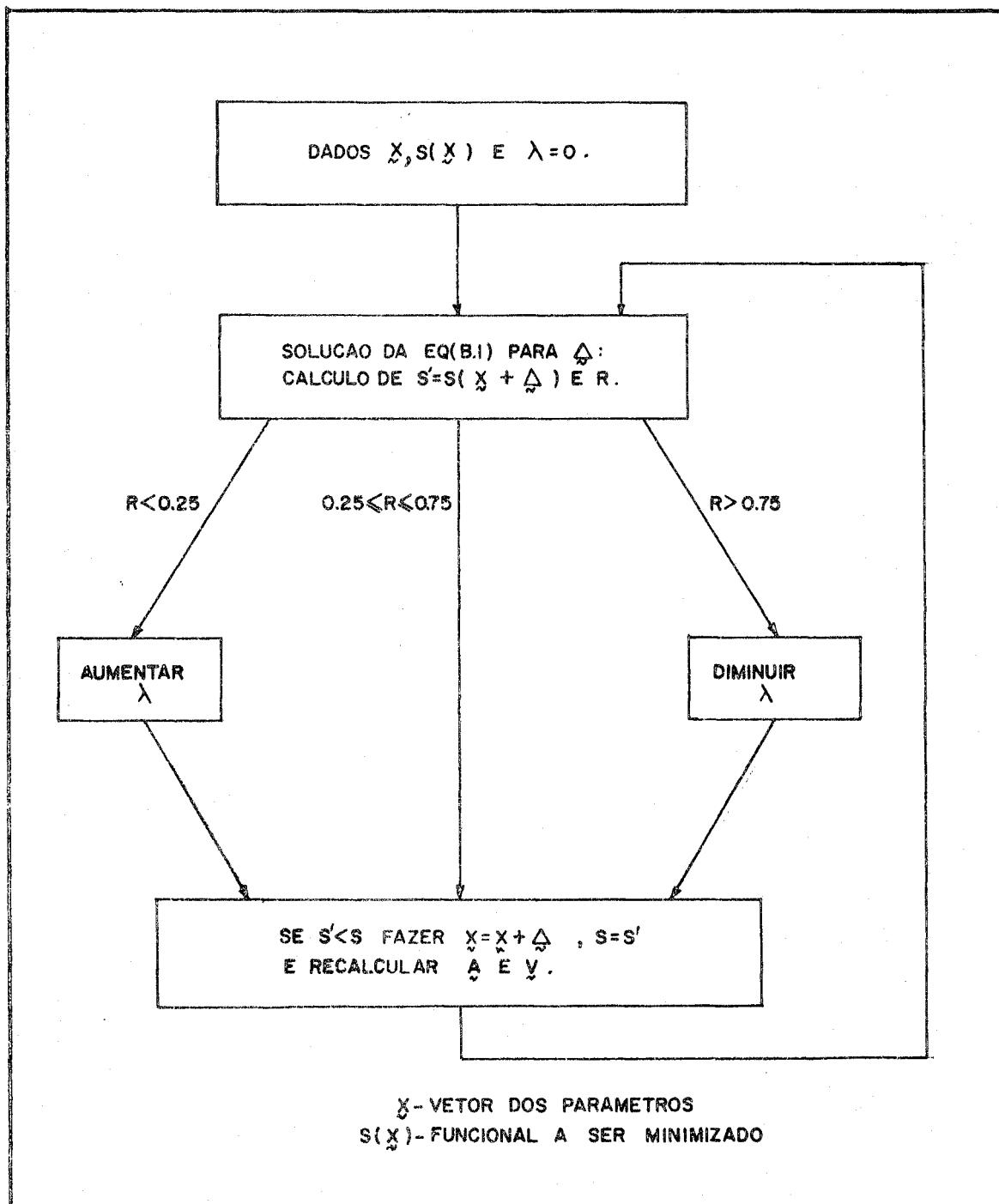
Fig.(B.2)- Fluxograma do algoritmo de Fletcher (1971).
