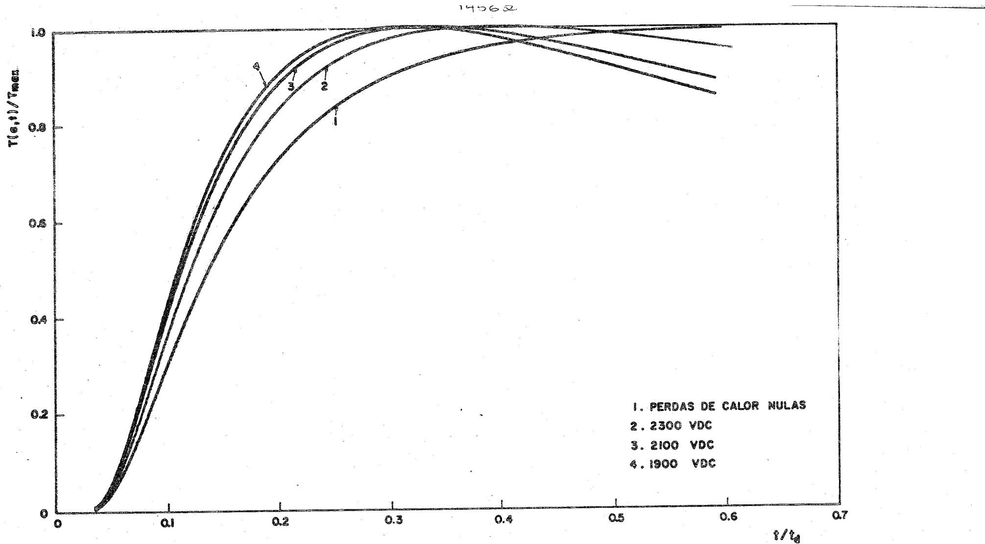
Fig.(4.3)- Efeito de perdas de calor na determinação de  $t_d$
