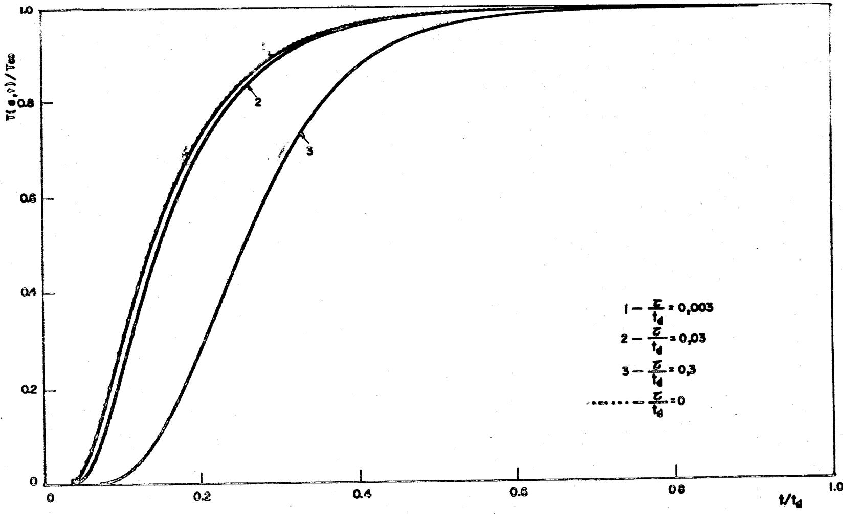
Fig.(2.3)- Efeito de pulso de tempo finito no transiente de temperatura .
