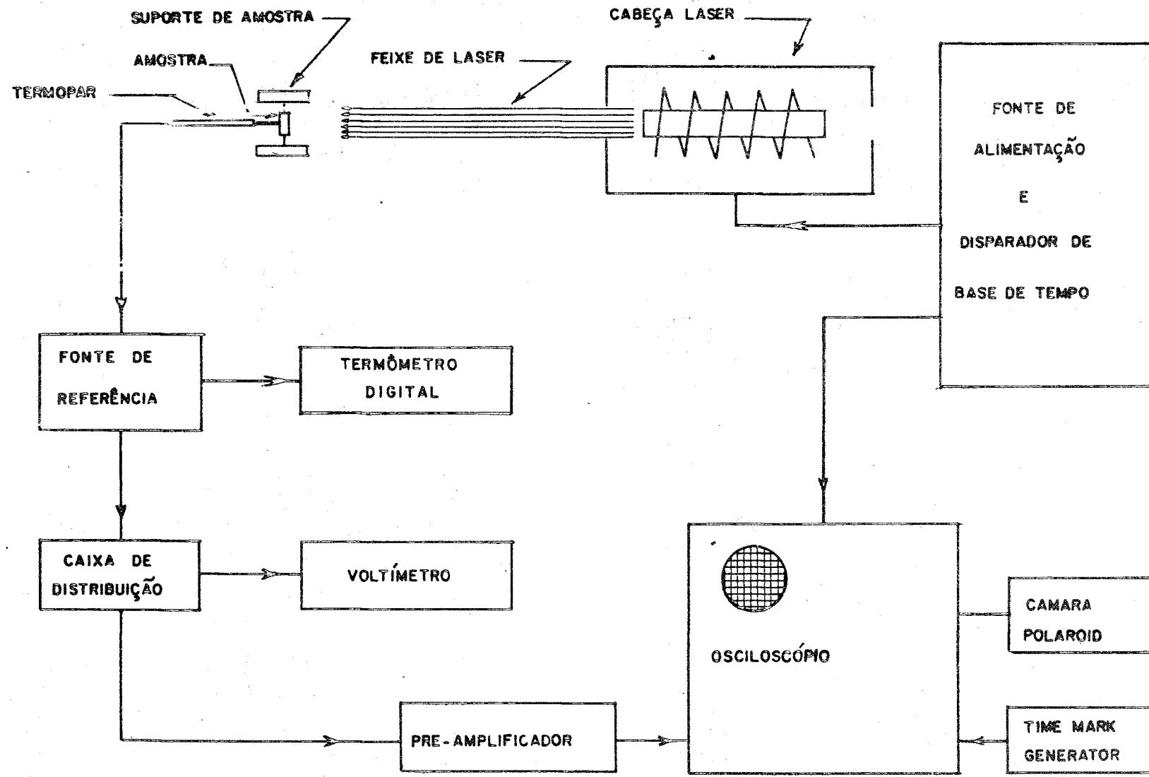
Fig.(3.1)- Arranjo experimental para medição da difusividade térmica .
