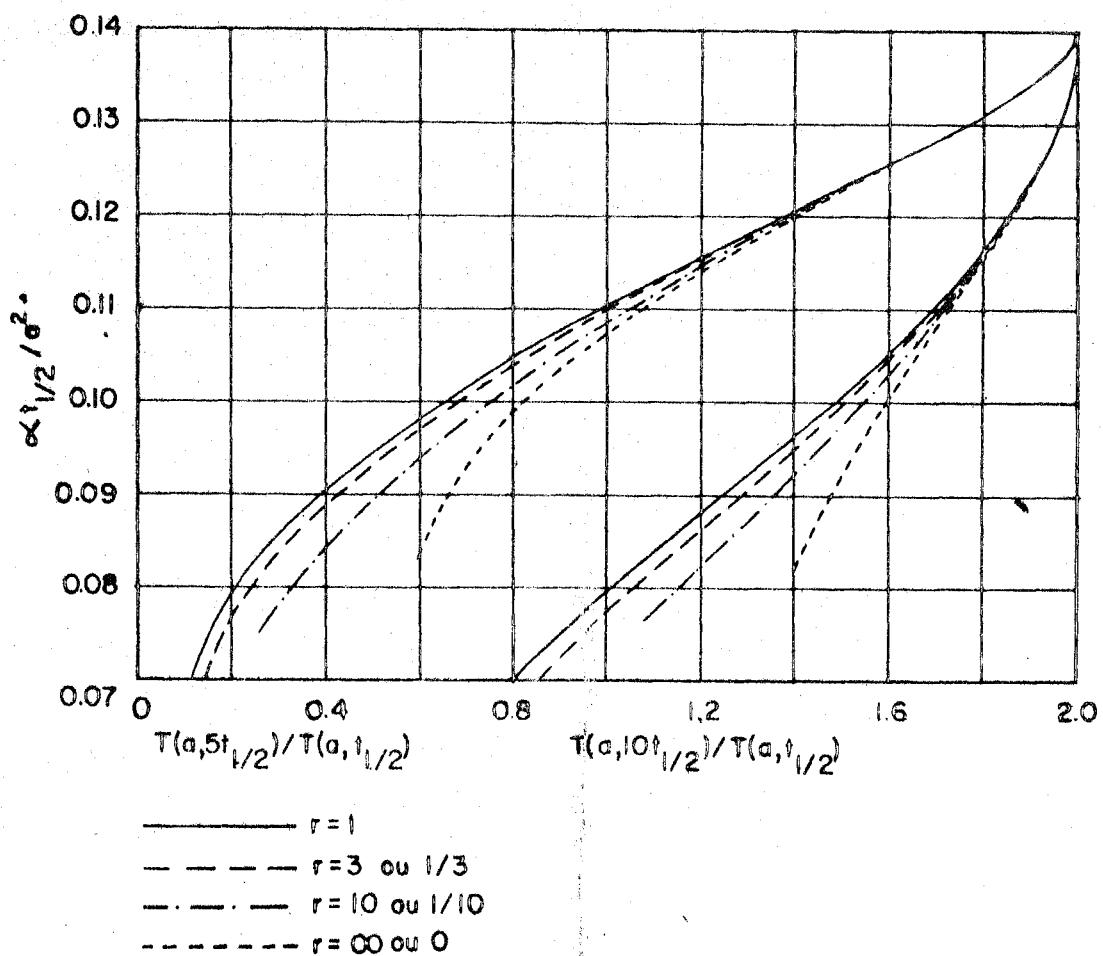
Fig.(2.5)- Estimativa de  $\alpha_t^{1/2}/a^2$  a partir do transiente de temperatura experimental (Cowan (1963)).
