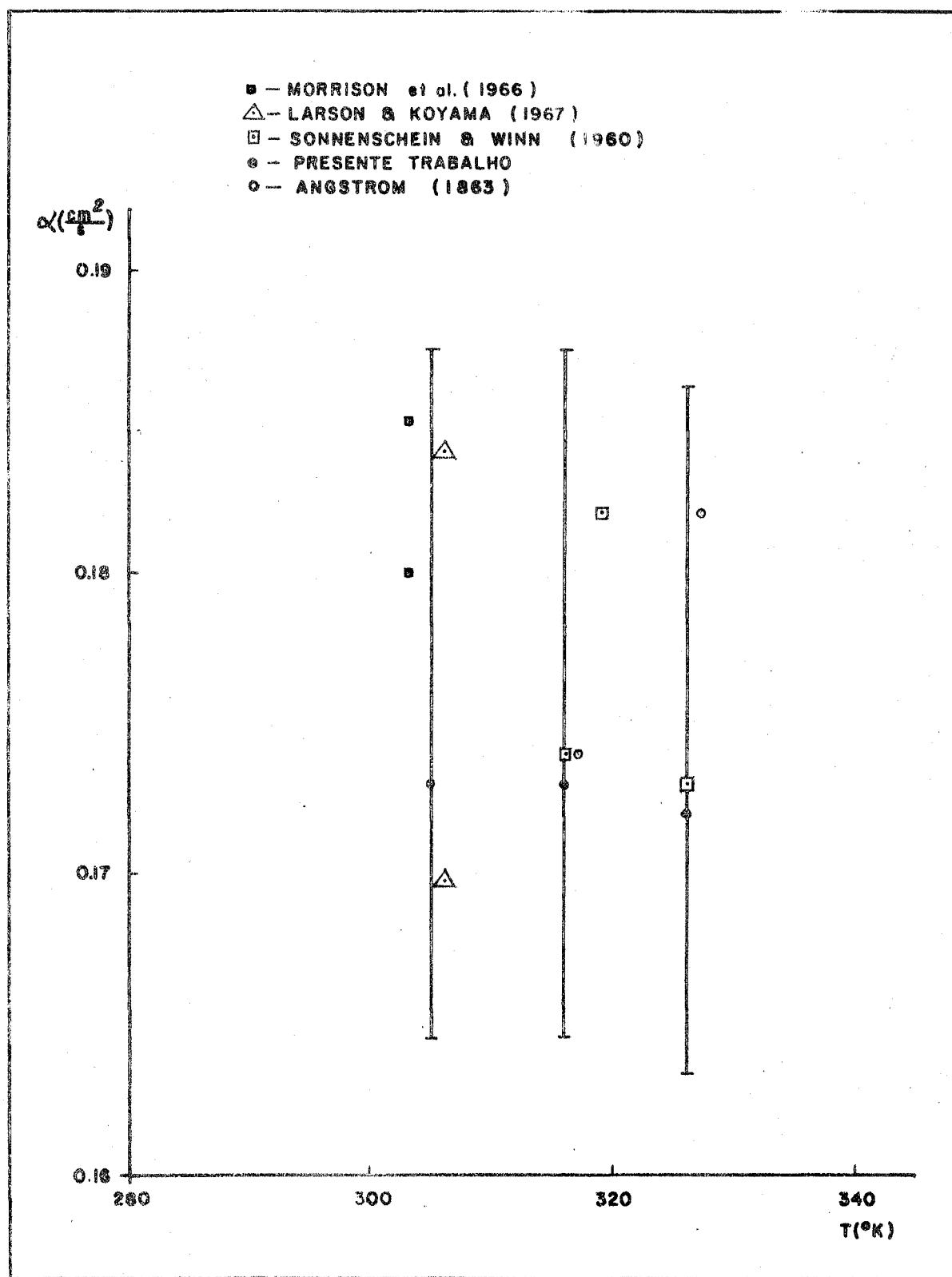
Fig.(4.5)- Difusividade térmica de ferro de alta pureza .
