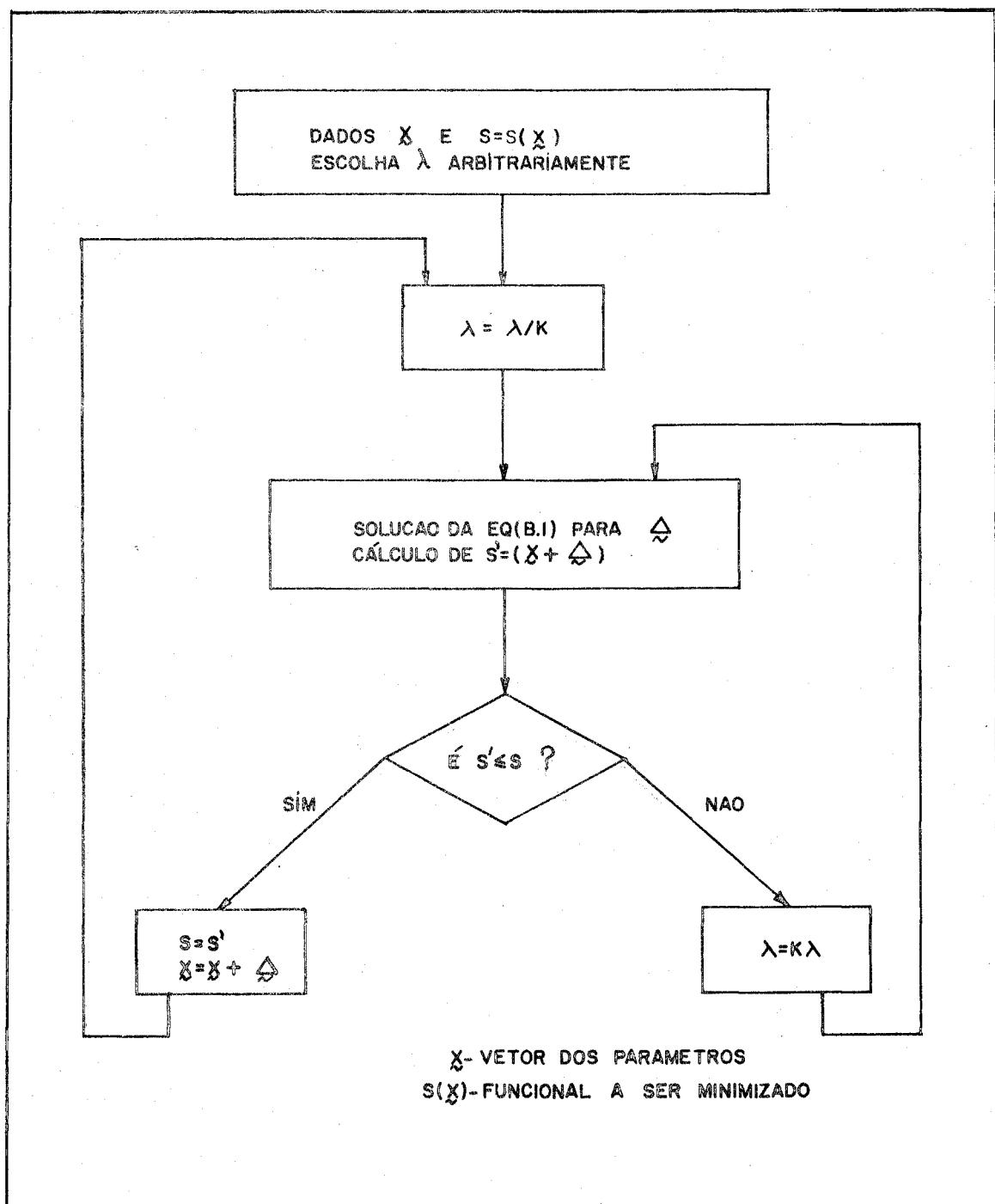
Fig.(B.1)- Fluxograma do algoritmo de Marquardt ( 1963 ) .
