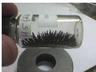
Figura 3 – Nanopartículas de magnetita sob ação de campo magnético
