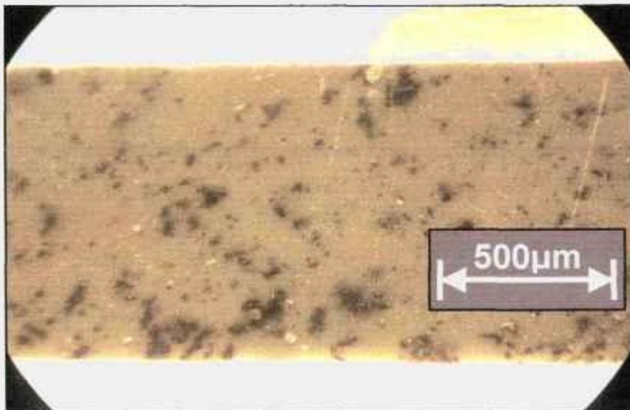
*Figura 27* – Foto com aumento aproximado de 100 vezes da seção transversal de corpo de prova após ataque hidrolítico por durante 14 dias, da amostra KFR40, com espessura aproximada de 1,0mm
