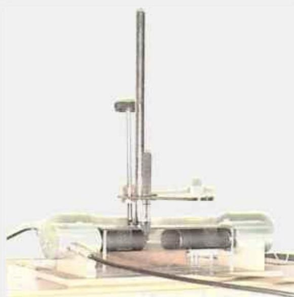
FIGURA 5.6 – Sistema mecânico de ajuste da posição da fonte radioativa.
