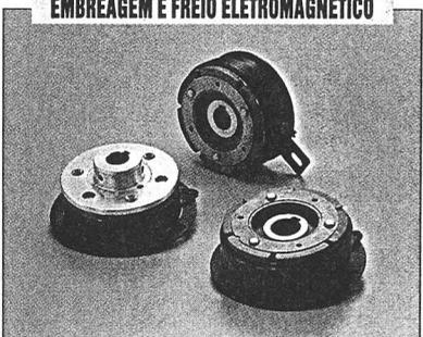
Alta performance, precisão de posicionamento, resposta rápida e estável com dimensões compactas e várias opções de flanges e armaduras. Disponíveis com torque entre 0,2-320 Nm e furos Ø 5-60 mm.
