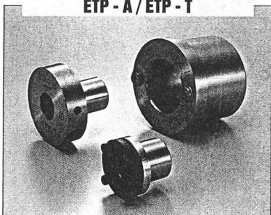
Buchas de fixação com sistema hidro-friccional. Disponíveis nas seguintes dimensões: ETP-A: Ø 15-100 mm / Torque: 43-12.500 Nm. ETP-T: Ø 15-70 mm / Torque: 40-6.500 Nm.
