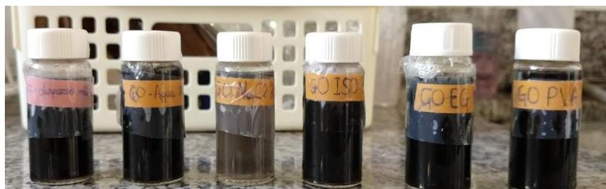
**Figura 5:** Da direita para a esquerda dispersões antes do banho ultrassônico de OG não irradiado e as dispersões irradiadas de Água (disperso), NaCl, ISO, EG, PVA.
