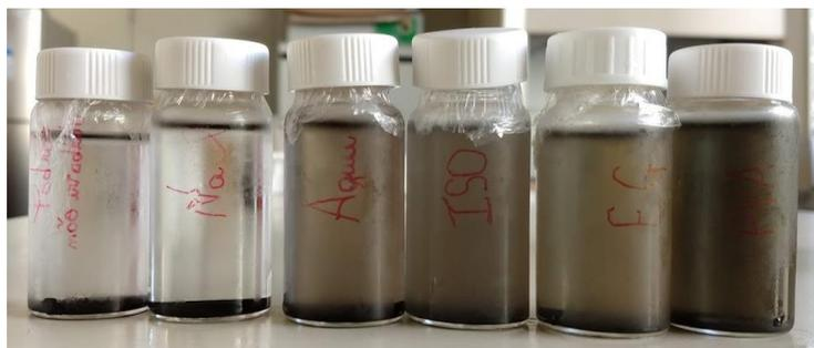
**Figura 4:** Da direita para a esquerda dispersões antes do banho ultrassônico de OG não irradiado e as dispersões irradiadas de NaCl, Água (disperso), ISO, EG, PVA.
