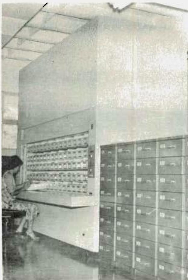
**Figura 6** – Equipamento eletrônico para armazenagem de microfichas
