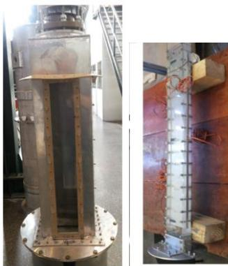
Figura 2: Seção de Testes com o simulador instrumentado do elemento combustível.
