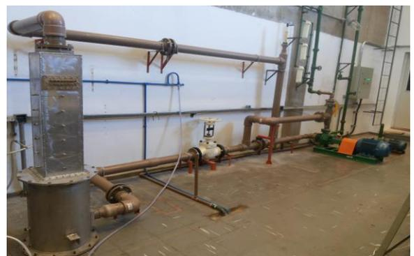
Figura 1: Bancada Velocidade Crítica.
