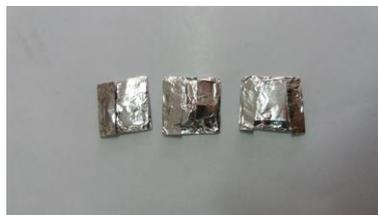
FIGURA 9: Amostra pré-concentrada por liofilização ou calcinação, padrão pipetado e material de referência cobertos com papel alumínio para irradiação de longa duração
