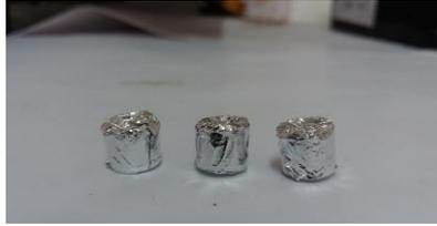
FIGURA 10. Amostra pré-concentrada por evaporação, padrão pipetado e material de referência cobertos com papel alumínio para irradiação de longa duração
