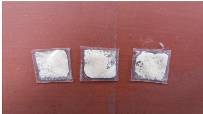
FIGURA 8: Cinzas da amostra de vinho calcinada, pesadas e seladas em envelopes de polietileno para análise.
