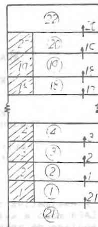
Figura 2 Modelagem utilizada nos programas RELAP4 simulando a seção de testes 403
