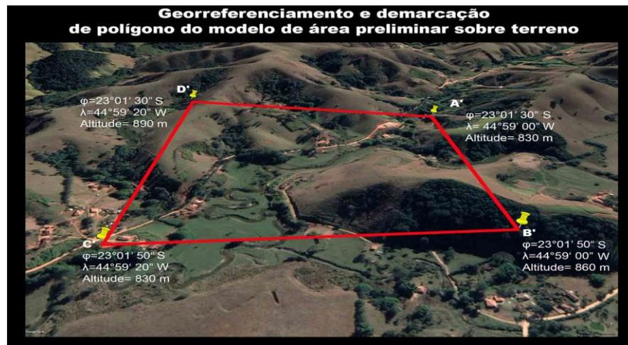
**Figura 51.** Demarcação do perímetro referente ao modelo de área preliminar segundo pontos georreferenciados e conforme coordenadas geográficas e altitude.
