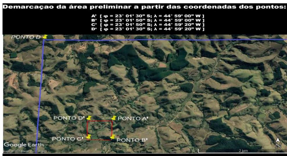
**Figura 49.** Modelo de área preliminar, delimitada pelas coordenadas A',B',C' e D', inserida no polígono da folha topográfica de Cunha, totalizando perímetro de 2,37 km e área total de 350,55 m<sup>2</sup>.
