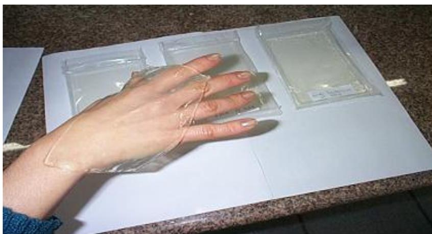
**Figura 1** - Visualização das membranas de hidrogel prontas para serem usadas em testes de retenção de resíduos radioativos.
