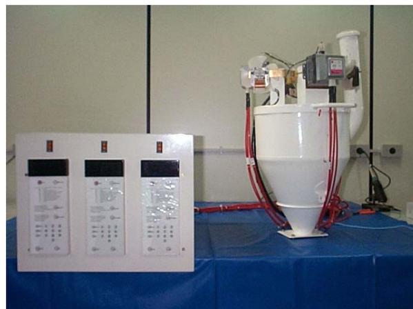
**Figura 1** – Unidade removível de geração de calor - Microondas
