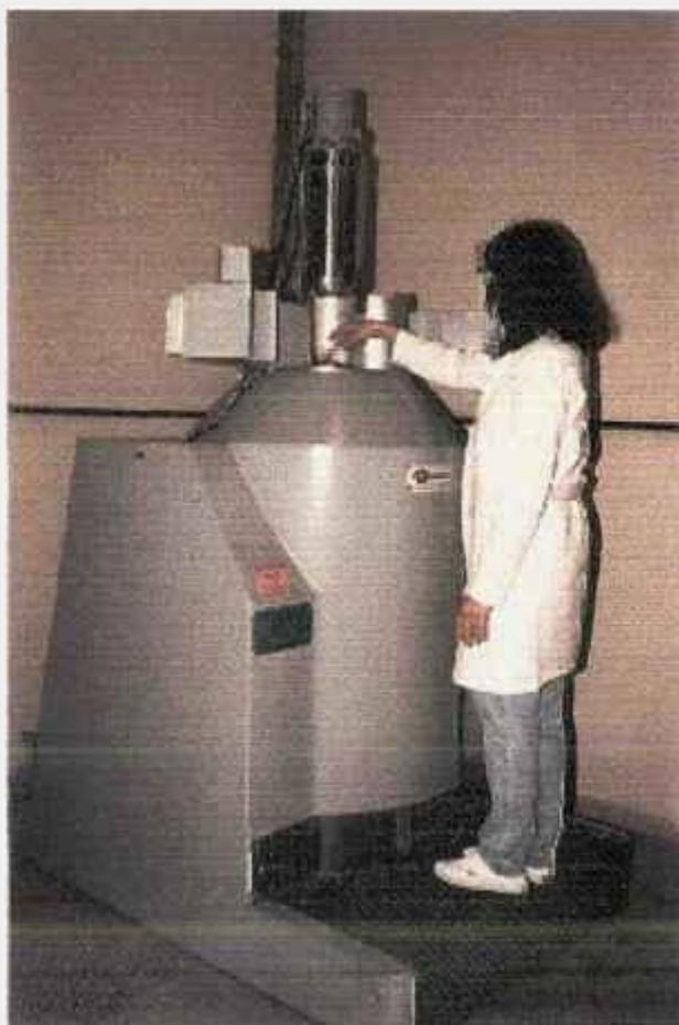
**Figura 3:** Fonte de Cobalto 60 – Gammacell 220 pertencente ao IPEN.
