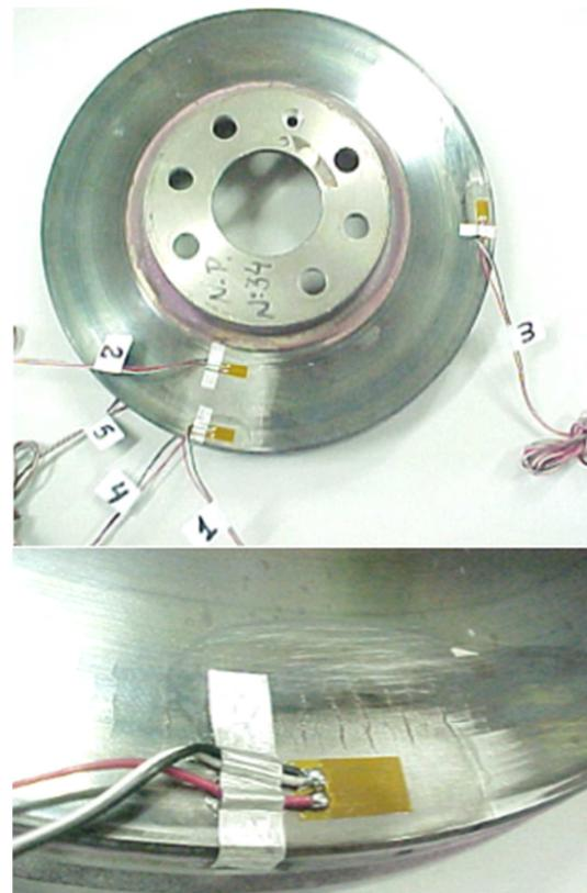
Figura 12 – Instrumentação dos discos de freio por *strain gage* unidirecionais.
