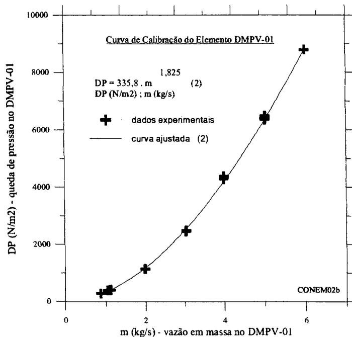
Figura 4. Curva de calibração do elemento DMPV-01.
