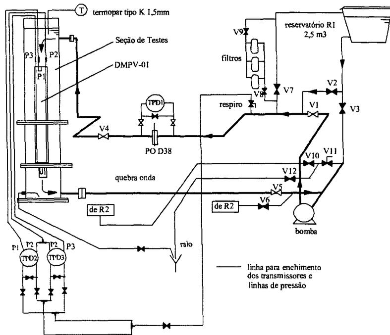
Figura 2. Circuito experimental, DMPV-01 e demais instrumentos usados.
