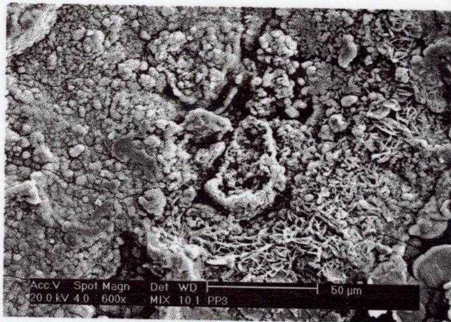
Figura 6.5.13 – Micrografia da amostra PP3, mostrando “bolas de algodão”, da goetita e “eflorescências laminares” da lepidocrocita, à direita, na região inferior.
