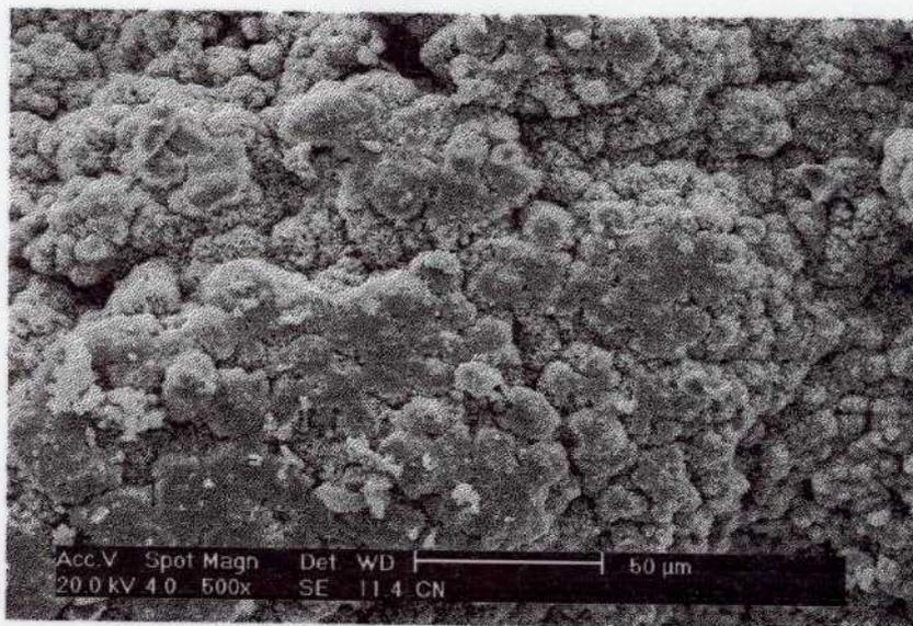
Figura 6.5.28 – Micrografia da amostra de aço comum, submetida ao ensaio UVCON alternado com Névoa Salina, mostrando estruturas achatadas de magnetita, e bolas de algodão, de goetita.
