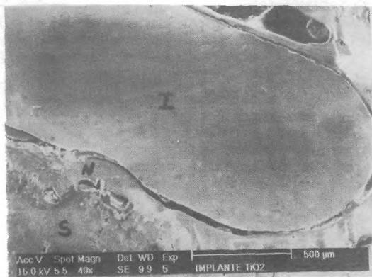
Fig.3- Micrografia por microscopia eletrônica de varredura:(I) implante de  $TiO_2$ ; (N) tecido neo-ósseo;(S) tecido ósseo secundário.
