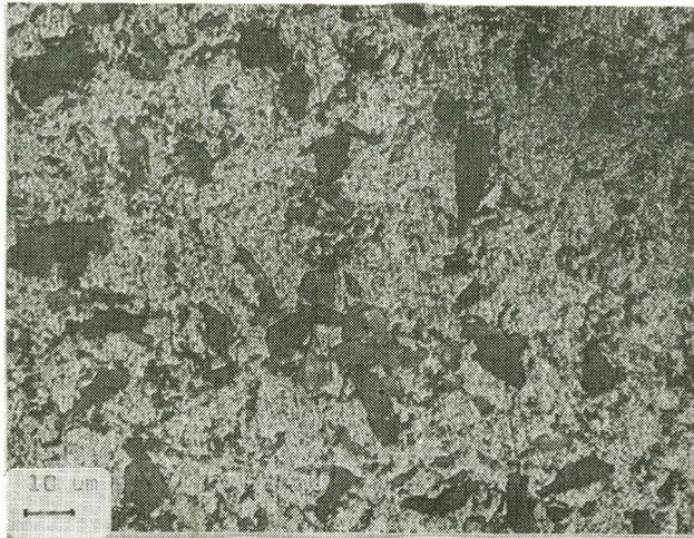
Figura 6. - Microestruturas do extrudado com 10% de reforço, sem ataque, mostrando aglomerados de  $\text{SiC}$  e óxidos.
