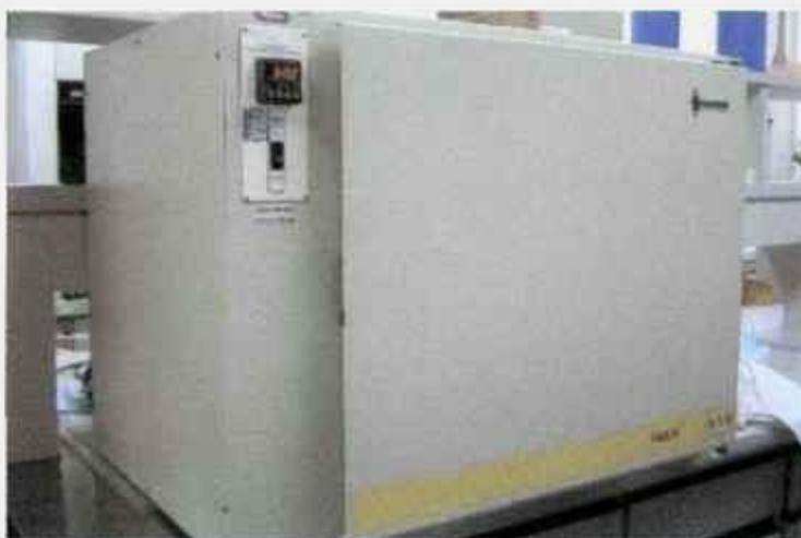
**Figura 20. Estufa utilizada para secagem dos géis.**
