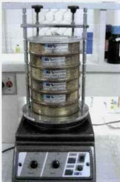
**Figura 21. Agitador mecânico de peneiras.**
