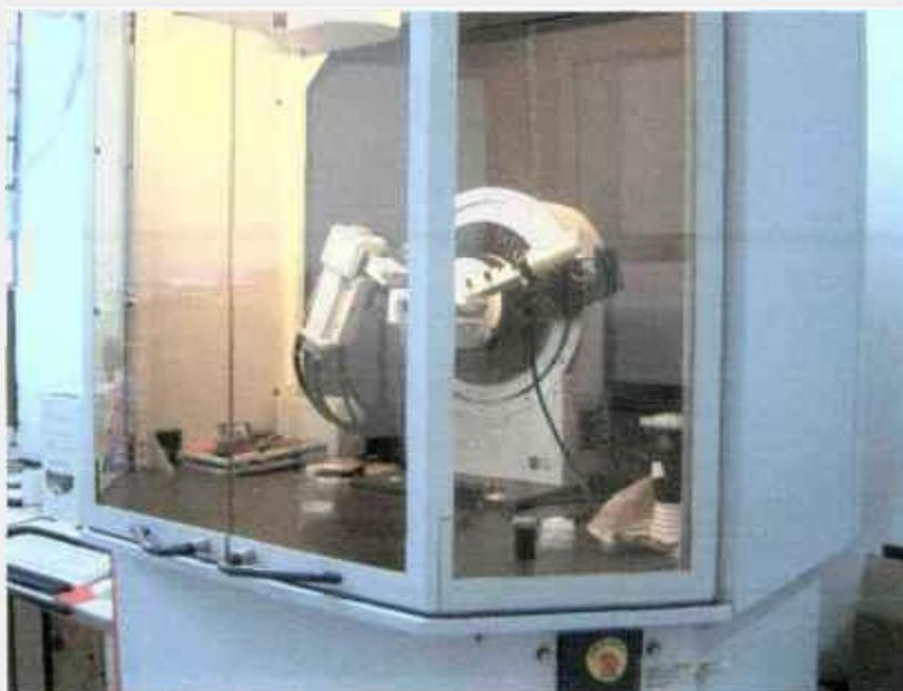
**Figura 23. Difratorômetro de raios-x do Departamento de Engenharia Metalúrgica (ME) do IPEN-CNEN/SP, visto de longe.**
