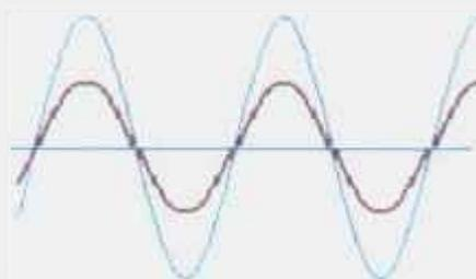
**Figura 24. Ondas com interferência construtiva.**
