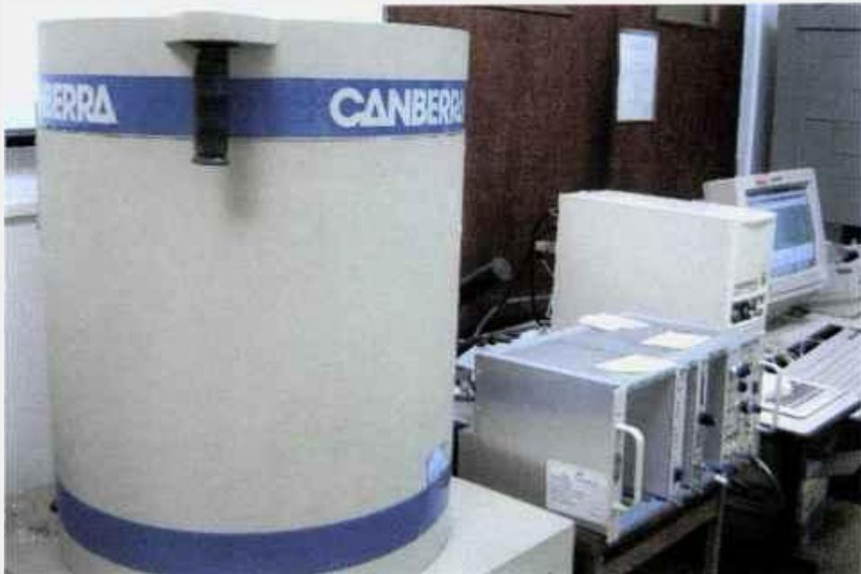
**Figura 14. Espectrômetro de radiação gama do Centro de Radiofarmácia do IPEN-CNEN/SP.**
