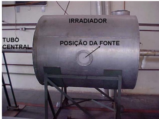
Figura. 1 – Foto do Irradiador com detalhes da posição da fonte de nêutrons.
