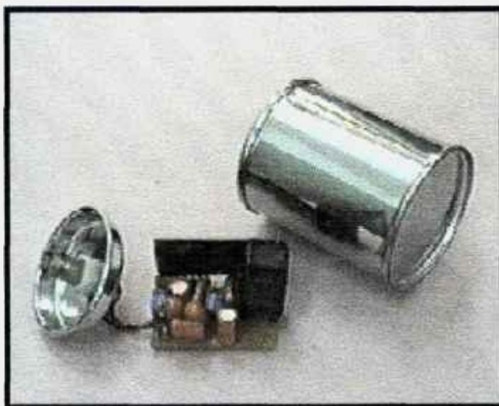
Figura 4.9 – Aspecto final do conjunto detector e pré-amplificador, removidos para melhor visualização. O recipiente que contém o detector é revestido internamente com espuma para proteção mecânica do conjunto.
