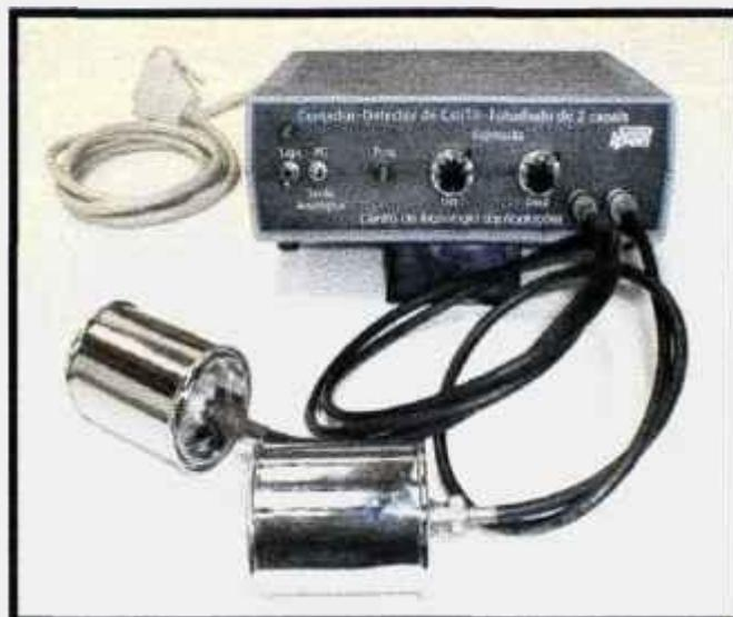
Figura 4.12 – Unidade de amplificação e processamento de sinal, juntamente com os detectores, cabos de ligação e de comunicação que constituem o equipamento desenvolvido neste trabalho.
