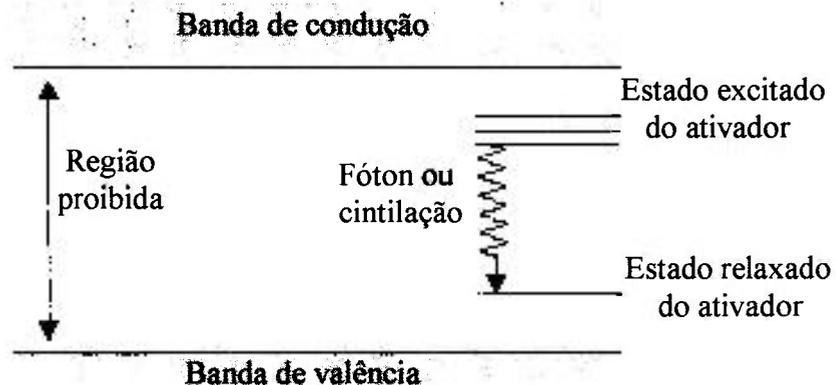
Figura 2.2 – Modelo de bandas de energia em um meio cristalino com ativador.
