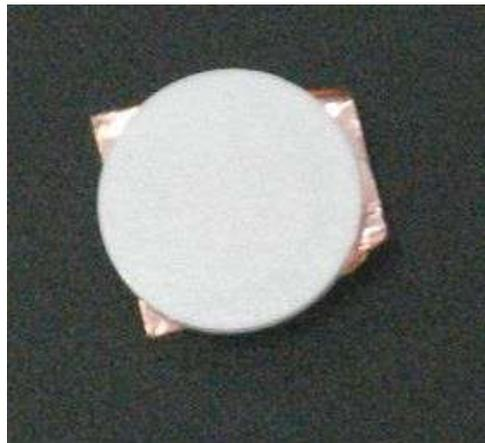
FIGURA 28. Pastilha obtida por prensagem a partir de 200mg de pó da matriz do compósito biodegradável PCL/HA.
