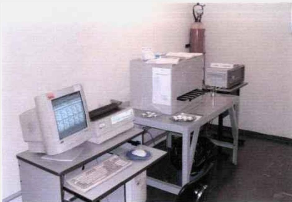
FIGURA 16 – Sistema para contagem no detector proporcional de fluxo gasoso modelo Berthold LB 770.
