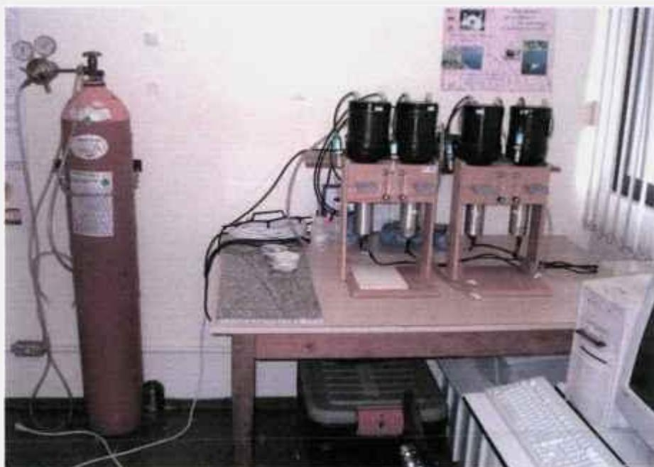
FIGURA 15 – Sistema de coincidências atrasadas, com células de cintilação de 1,1 L utilizado para a determinação de  $^{223}\text{Ra}$  e  $^{224}\text{Ra}$  nas amostras de água de superfície e água subterrânea.
