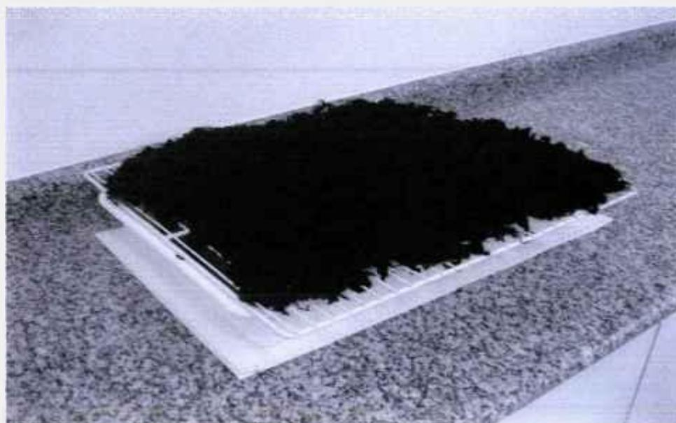
FIGURA 5 – Fibras de acrílico impregnadas com  $\text{MnO}_2$ .
