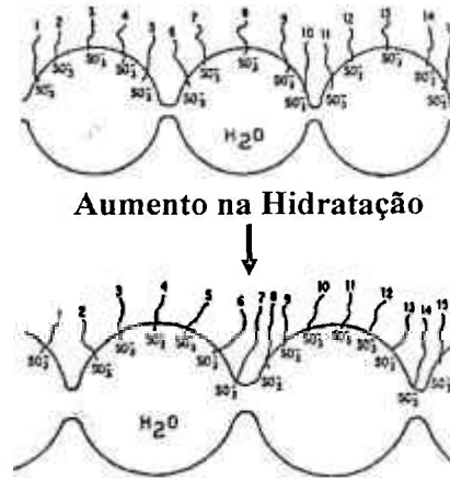
Figura 3.6 – Esquema da expansão morfológica do Nafion hidratado [20,36].
