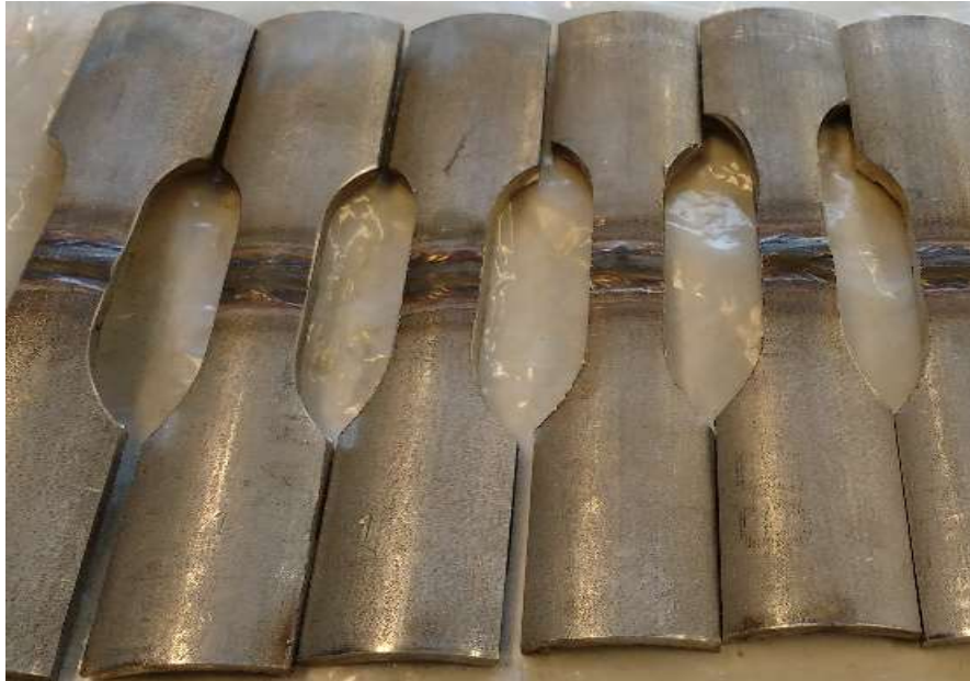
Figura 6 - Modelo de corpo-de-prova reduzido, para ensaio de tração[21].
