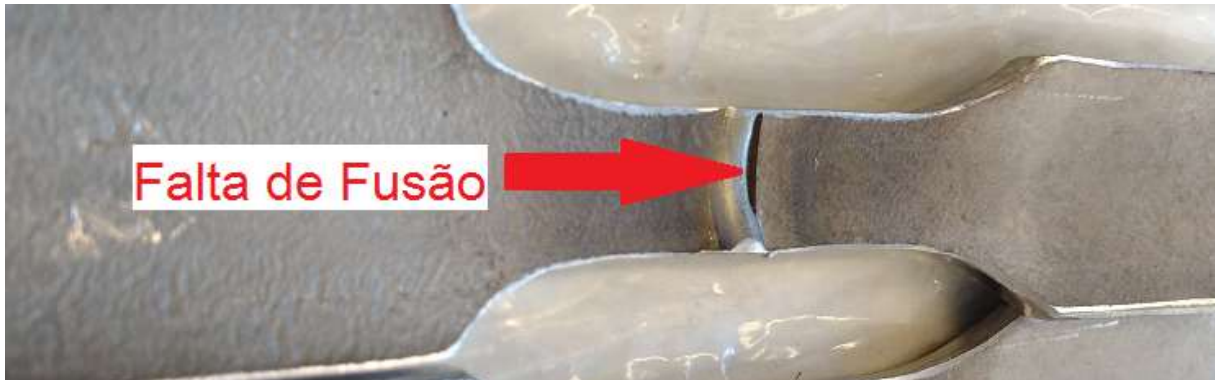
Figura 10 – Corpo-de-prova de tração com falta de fusão em um dos lados.
