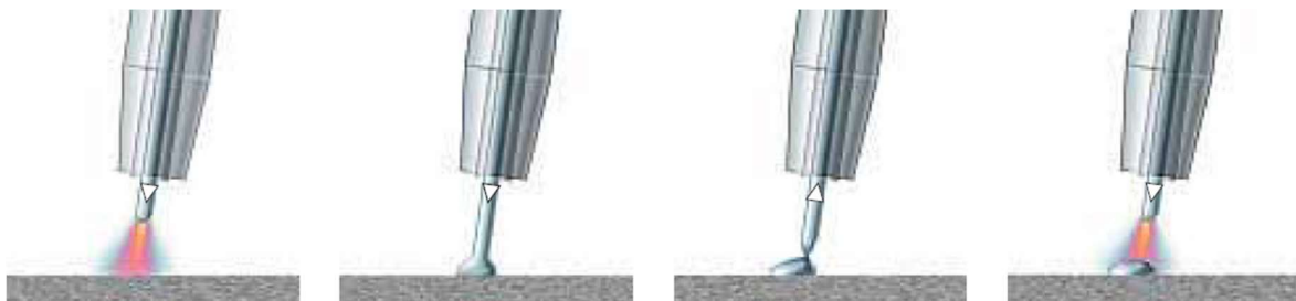
Figura 2: Sequência conforme de transferência metálica no processo de soldagem GMAW com controle CMT (Extraído do Data Sheet da Fronius “CMT: Cold Metal Transfer ”).
