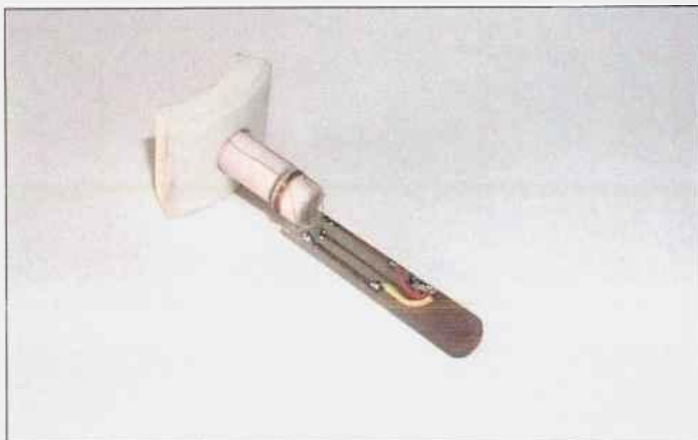
Figura 37. Detalhes internos da sonda desenvolvida antes do encapsulamento.
