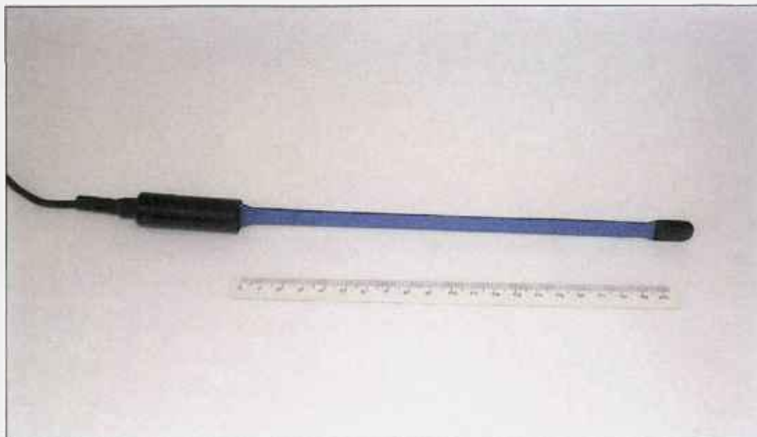
Figura 44. Aspecto final da sonda para construída para combustíveis do tipo placa.
