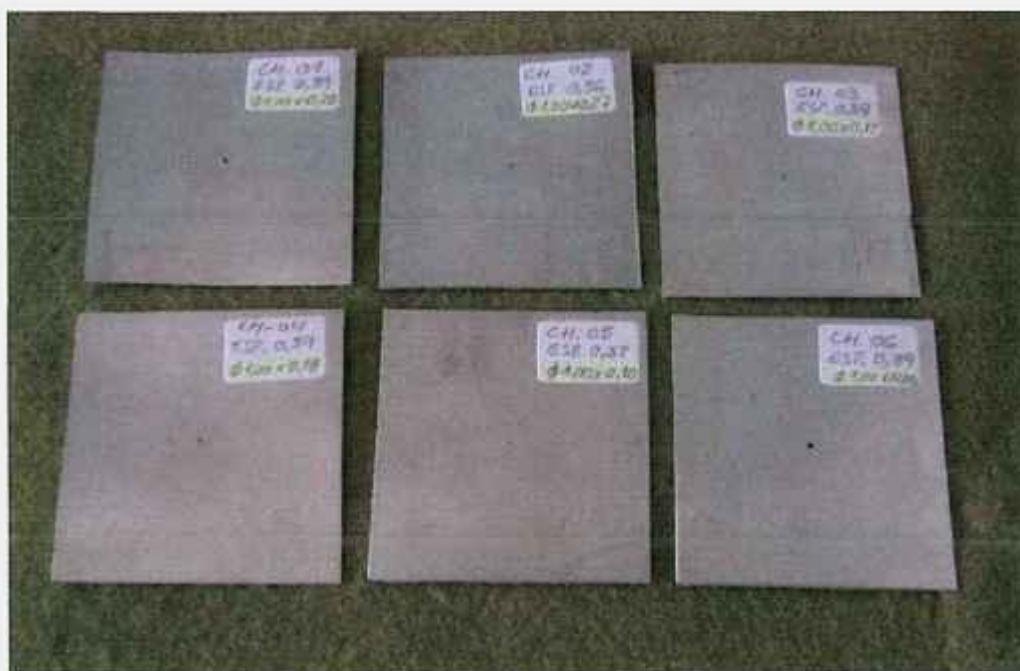
Figura 33. Descontinuidades usinadas do tipo orifício.
