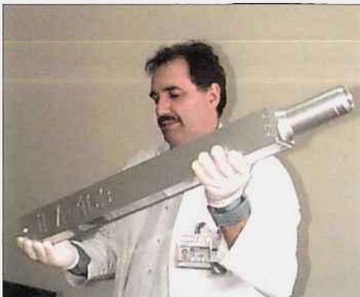
Figura 6. Aspecto de elemento combustível do reator IEA-R1 (IPEN, 2004).
