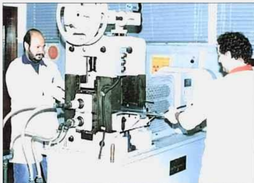
Figura 26. Laminação de combustível no CCN (IPEN, 2004).
