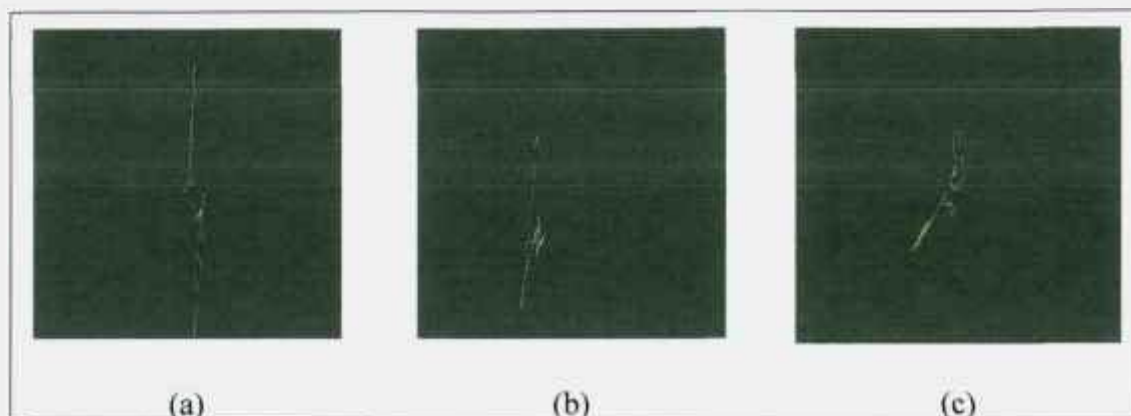
Figura 22. Sinais referentes aos sulcos de 1,0 mm (a), 0,5 mm (b) e 0,2 mm (c) (Silva Júnior e Alencar, 2003).
