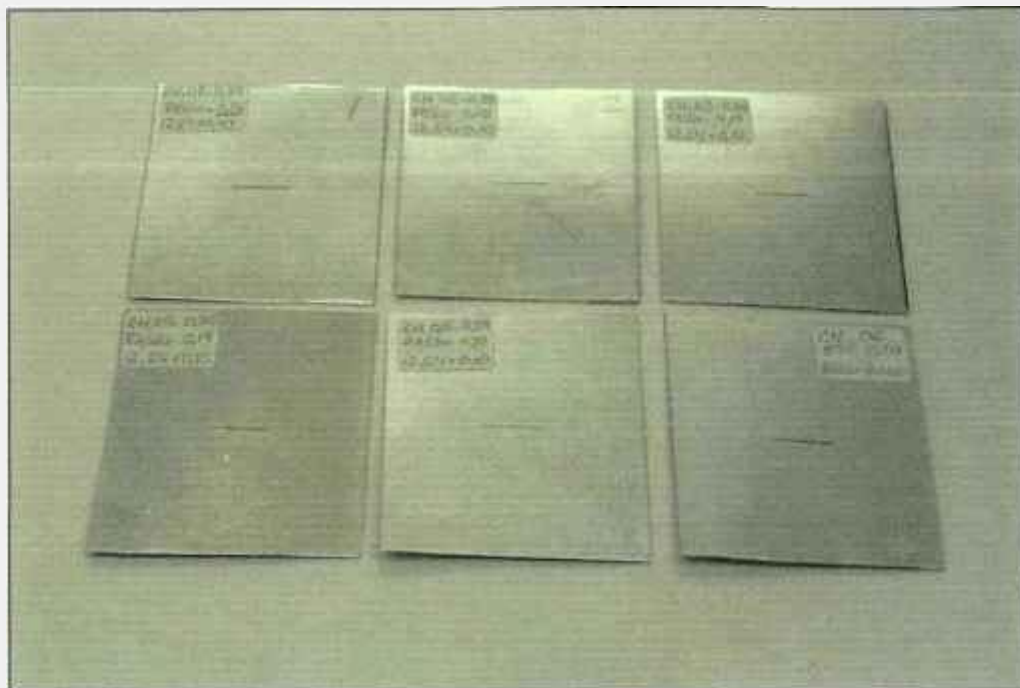
Figura 32. Descontinuidades usinadas do tipo sulco.
