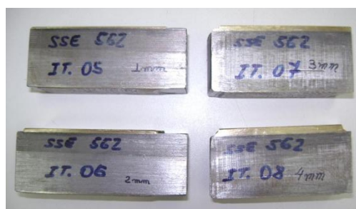
Figura 2. Peça de testes PT-04 na condição “como soldada” e usinada.
