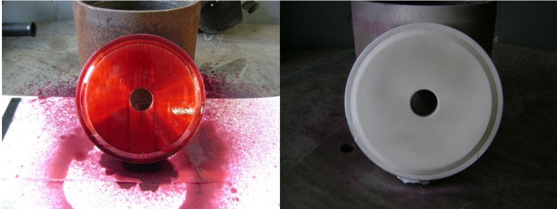
Figura 5. Peça de testes PT-04 sendo submetida ao ensaio por líquido penetrante.
