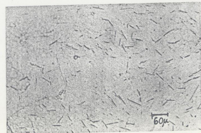
Figura 8 - Micrografia da amostra com 50 ppm de hidrogênio temperada em óleo.
