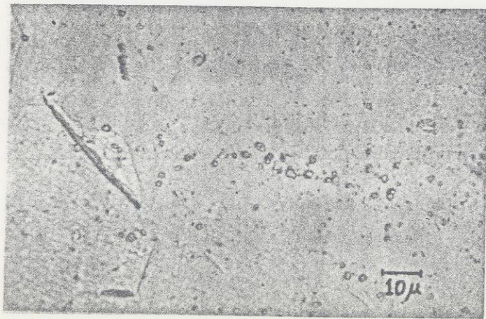
Figura 2 - Micrografia da amostra com 50 ppm de hidrogênio, resfriada dentro do forno.
