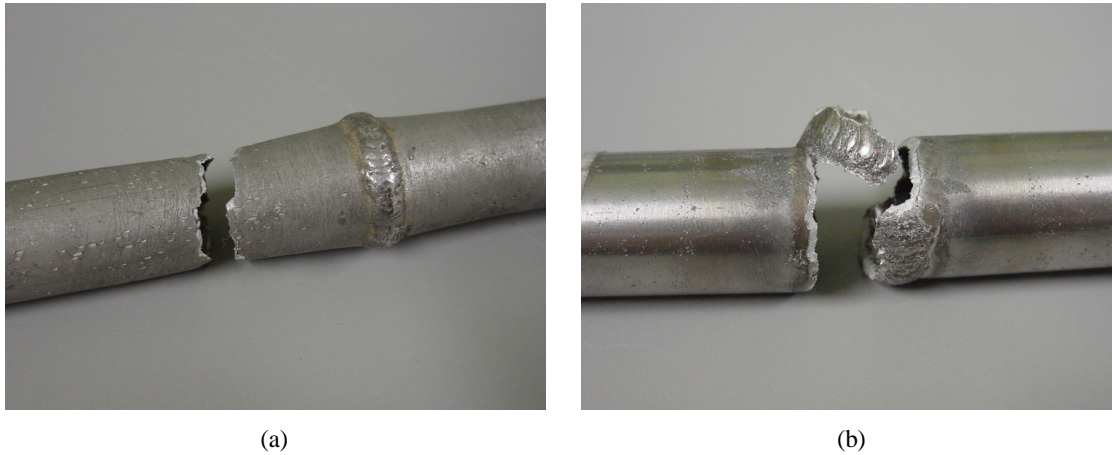
Figura 6: Amostra submetida ao ensaio de tração com MA (a) AISI 316 L e (b) UNS s 32750.
