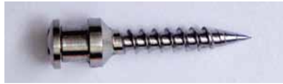
FIGURA 1 - Protótipo de mini-implante com o parafuso rosqueável, numa vista lateral.
