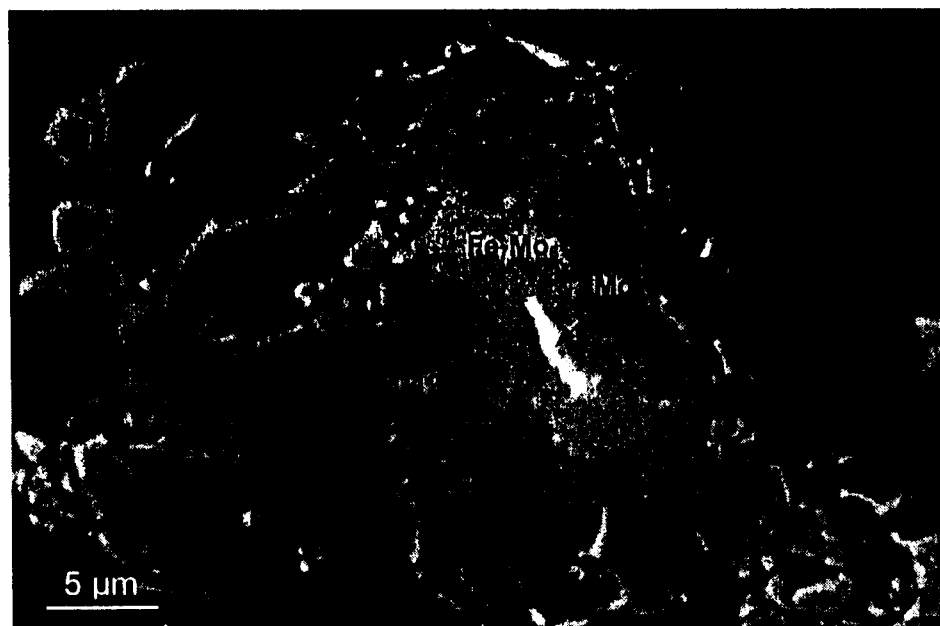
Figura 3.16 - Imagem de elétrons retro-espalhados da liga \text{NdFe}_{10,5}\text{Mo}_{1,5} : (a) fase 1:12 (fase cinza); (b) fase \text{Fe}_7\text{Mo}_6 (fase cinza clara) e (c) Mo (fase branca).
