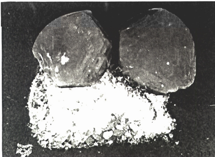
Figura 2 - Cristais de alúmen, obtidos com cristalização lenta (maiores) e rápida (menores)
