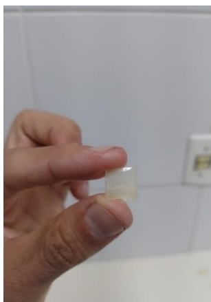
Figura 29 e 30: Dosímetro selado em material termoplástico (TLD – LiF: Mg,Ti) – fornecidos pelo IPEN.
