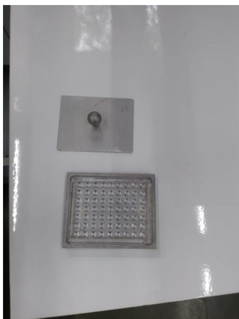
Figura 37: Estojo para acomodação dos dosímetros após leitura. Estojo próprio para submeter dosímetros ao forno de tratamento (identificado em uma matriz).
