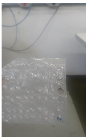
Figura 29 e 30: Dosímetro selado em material termoplástico (TLD – LiF: Mg,Ti) – fornecidos pelo IPEN.
