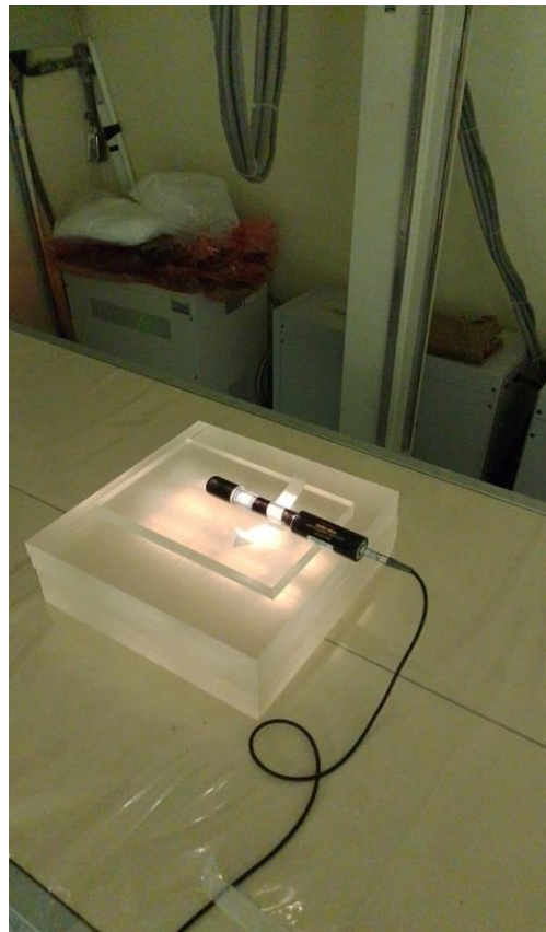
Figura 44: Câmara de ionização, estilo caneta, marca Radcal Accu Dose, modelo 2086, sonda de 10X6
