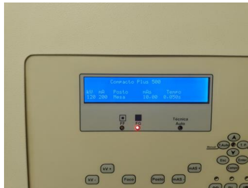
Figura 41: Painel com fatores energéticos utilizados durante calibrações : Aparelho de Raios-x Philips _ VMI Rotax – Compact Plus 500 (Laboratório de Radiologia da UNIFESP)
