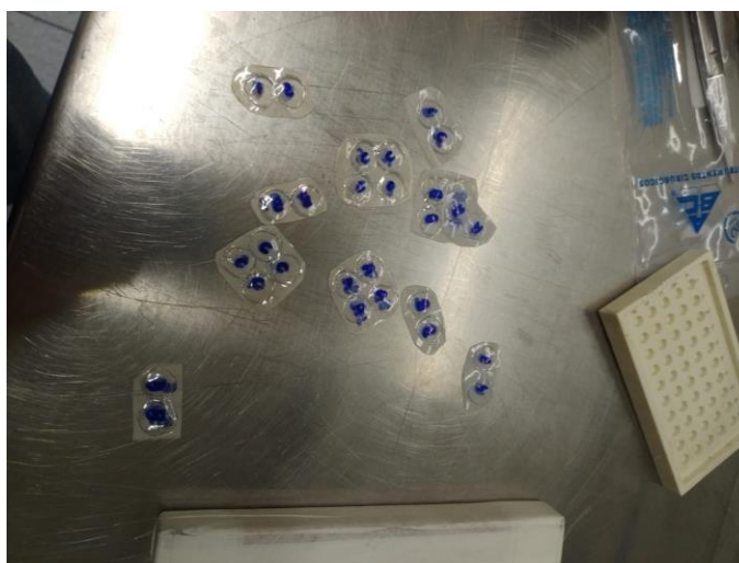
Figura 36 – Dosímetros selados em material plástico e identificados por combinação letra/número.
