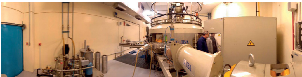
3 Acelerador Cíclotron Cyclone-30 (30 MeV), da Ion Beam Applications (IBA) , Bélgica. Crédito: Henrique Barcellos de Oliveira.
