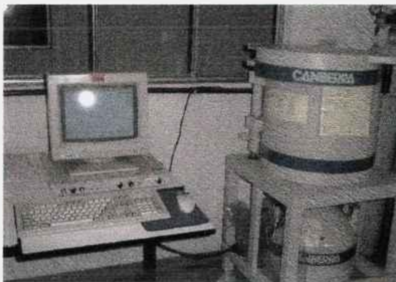
FIGURA 3.8 - Aspecto de laboratório do LAN com o espectrômetro CANBERRA GX 2020
