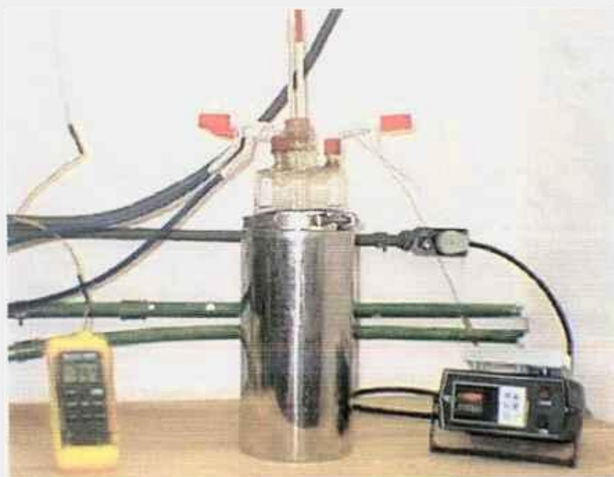
Figura 4.4.3.3: Vista da célula 3 de desidratação do eletrólito e do sistema de aquecimento.
