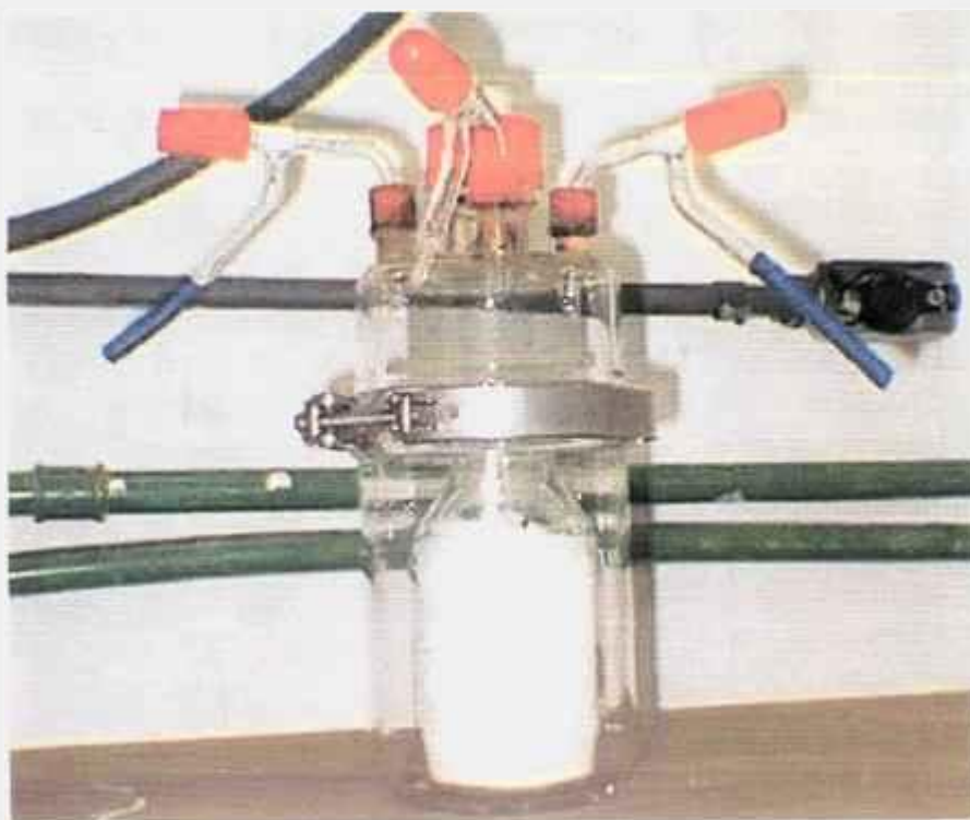
Figura 4.4.3.2: Vista da célula de desidratação 3 do eletrólito.
