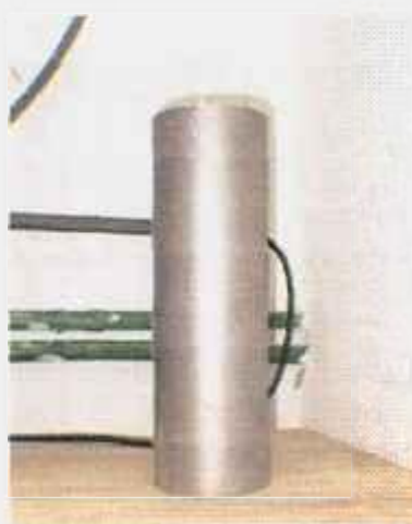
Figura 4.7.1: Vista de um cadinho confeccionado em aço inoxidável AISI 316L.
