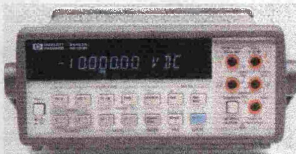
Figura 4.14 Multímetro Digital HP34401A utilizado na parte experimental
