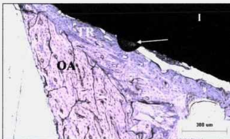
Figura 42. - Micrografia, obtida por microscopia de luz em lâmina corada pelo método de Azul de Toluidina, da liga Ti-13Nb-13Zr sinterizada a 1300 °C – Verifica-se sítios de contato entre a superfície do implante (I) e o tecido remodelado (TR). A seta aponta uma bolha resultante da colagem do corte histológico sobre lâmina de acrílico com cola à base de cianoacrilato.
