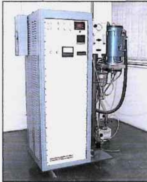
Figura 6. - Forno utilizado para realização da hidratação dos pós elementares e para a sinterização dos compactados (Thermal Technology Inc. – Astro 1000), pertencente à Divisão de Materiais do Centro Técnico Aeroespacial – São José dos Campos – SP).
