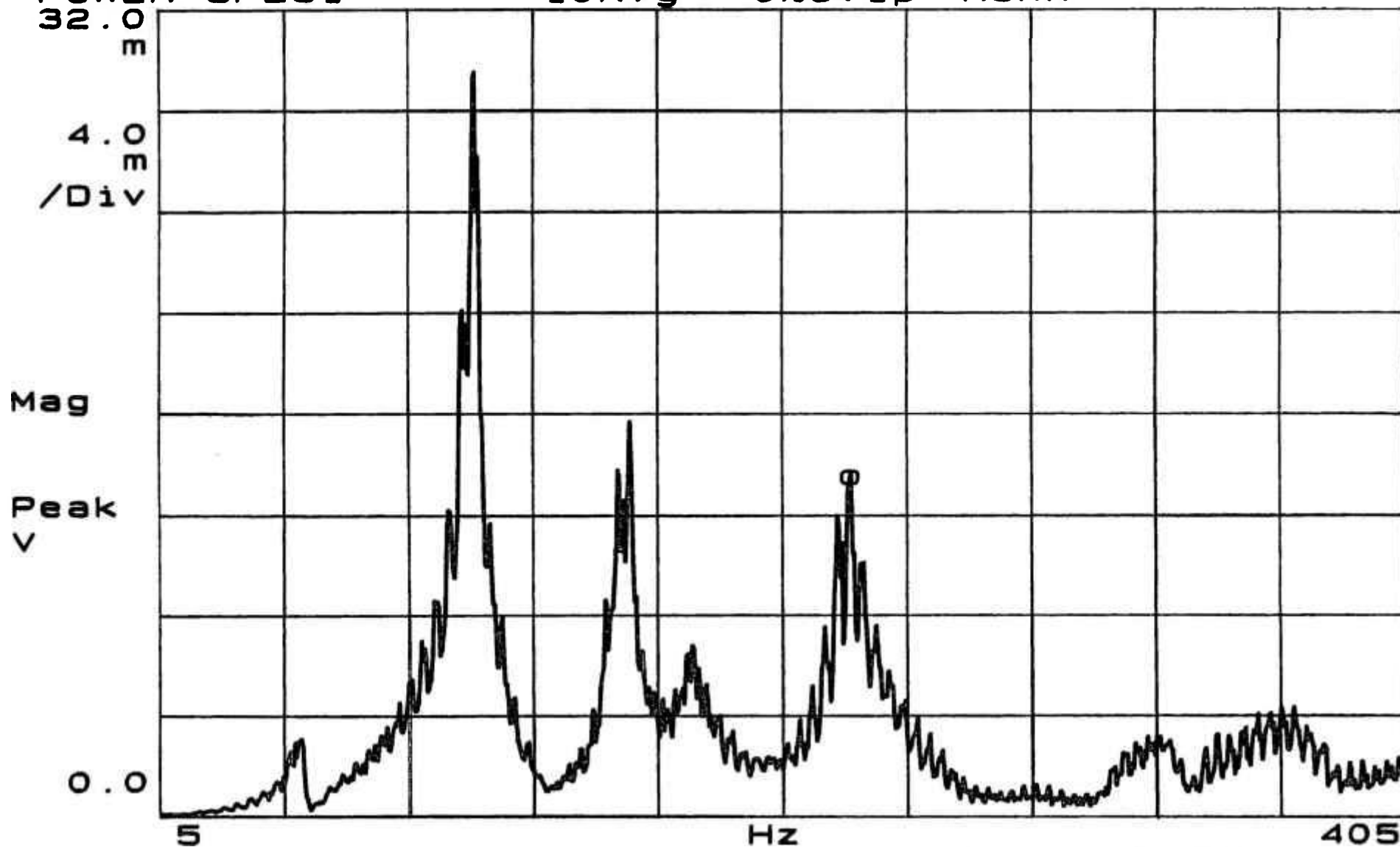
Figura 4.25 - Ensaio de frequência natural - entalhe horizontal - 226,5 Hz
