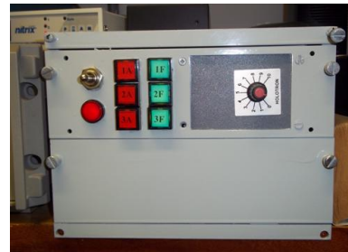
Figura 2. Painel de Controle do Sistema Irradiador Gama STS OB85/1 do LCI-IPEN-CNEN/SP utilizado na calibração de monitores portáteis de radiação.
