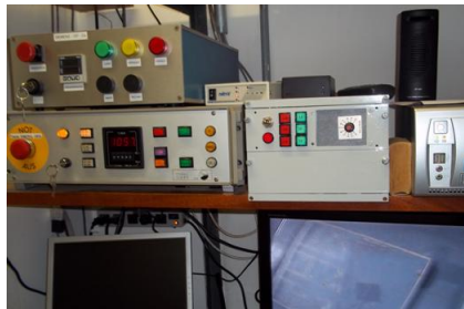
Figura 2. Painel de Controle do Sistema Irradiador Gama STS OB85/1 do LCI-IPEN-CNEN/SP utilizado na calibração de monitores portáteis de radiação.
