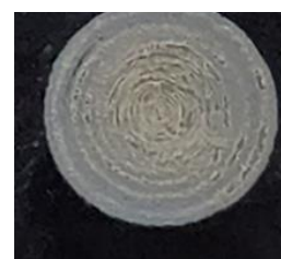
Figura 21 - Anéis de difração no perfil espacial dos pulsos laser provocados pela optica do sistema laser
