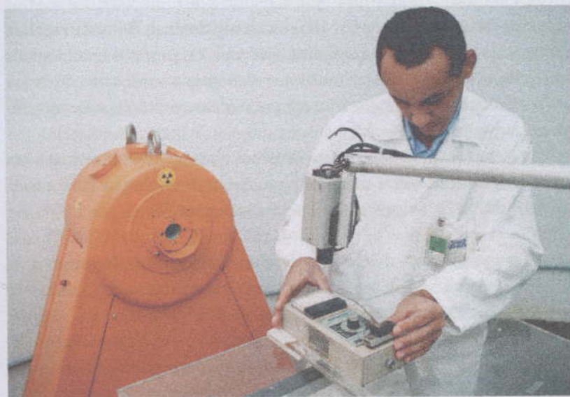
14 Calibração de monitores portáteis com radiação gama. Crédito: Marcello Vitorino/Fullpress.
