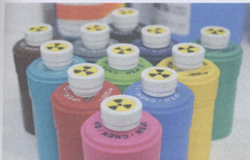
6 Conjunto de blindagens de chumbo para marcação de reagentes liofilizados com ^{99m}\text{Tc} . Crédito: E. R. Paiva.
