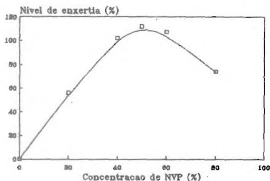
Fig.1- Efeito da concentração de NVP na enxertia sobre tubos de SR. Dose de irradiação: 9 kGy, taxa de dose: 0,12 kGy/h.
