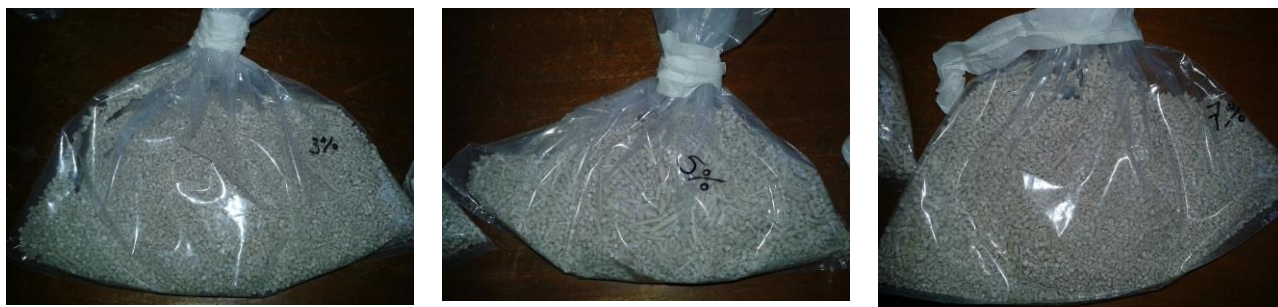
Figura 01 - Grânulos produzidos nos percentuais 3%, 5% e 7% (PSMACH3, PSMACH5 e PSMACH7)
